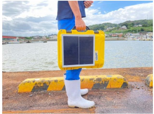
持ち運びしやすいトランク型で重量も7kg程度。
