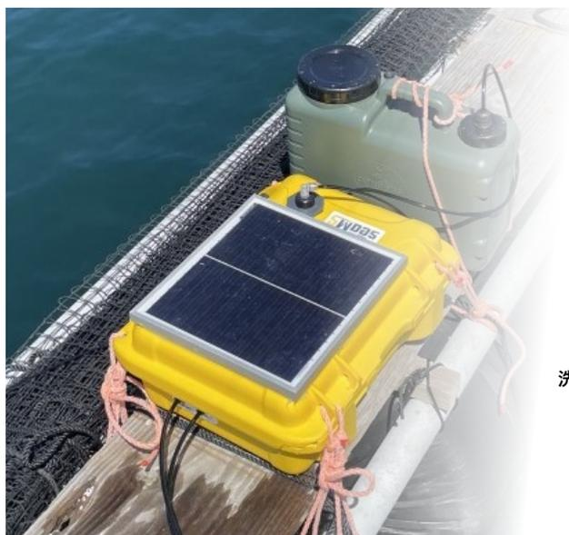
seaMS (自動顕鏡システム) とは採水→撮影→洗浄までの一連の動作を自動で行う、現場設置型の顕微鏡です。
